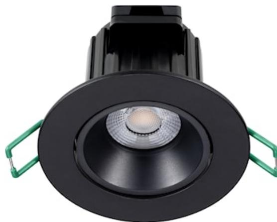
Integrierter LED-Einbaustrahler. Vertikal schwenkbar 30°. Schwarzer Aluminiumrahmen. Dimmbar. 3-CCT umschaltbar 2.700-3.000-4.000 K. 50° Abstrahlwinkel. Gehäuse aus Polycarbonat und Aluminium. Geringe Einbautiefe 62 mm. IP44 von vorne. IK07. Loop-in/Loop-out-Klemmen für schnelle Verkabelung. 68 mm Ausschnitt. Klare Linse. Zusätzliche weiße oder goldene Reflektoren können als Zubehör bestellt werden.
